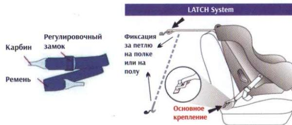
Главная особенность крепления Latch (американский стандарт) по сравнению с Isofix заключается в отсутствии металлической рамы и кронштейнов в конструкции кресла, что значительно облегчает его вес. Крепление осуществляется с помощью прочных ремней, которые фиксируются карабинами к скобам Latch на заднем сиденье автомобиля.
